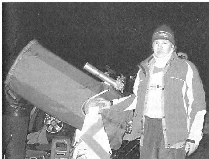
Призер конкурса телескопов С. Казаков у своего телескопа (система Ричи – Кретьена, диаметр зеркала – 465 мм, фокусное расстояние – 4101.4 мм, диаметр вторичного зеркала – 150 мм). Фото В.И. Щивьева.
